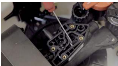
Sostituzione componenti interni valvola
